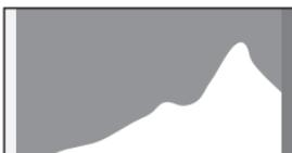
Cuando la imagen es demasiado oscura, la parte de la izquierda está recortada (partes oscuras) y cuando la imagen es demasiado brillante, la parte derecha está recortada (partes brillantes).
