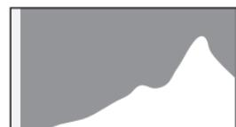
Cuando la imagen es demasiado oscura, la parte de la izquierda está recortada (partes oscuras) y cuando la imagen es demasiado brillante, la parte derecha está recortada (partes brillantes).
